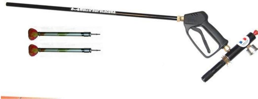
Le projecteur à gaz CO2 Captor S3 propulse des fléchettes hypodermiques « SWIFT » réutilisables sans organe de visée, simplement une visée ouverte. Equipé de 2 valves « on/off » de réglage de la distance de tir d'un indicateur de pression de propulsion de 0 à 20 bars et d'une valve de sécurité en cas de surpression. Il est principalement utilisé sur des animaux en cage ou pour des tirs à courte distance maxi 25 mètres.
